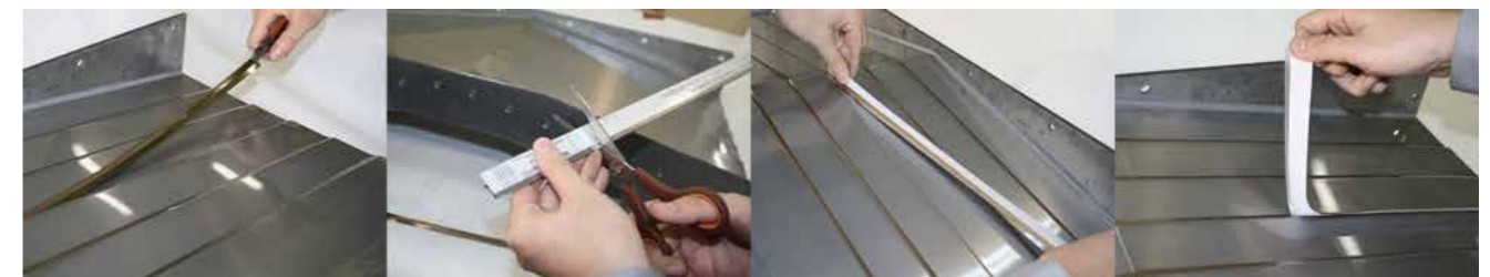
劣化したブレードを引き抜く 交換ブレードを規定の長さでカット ガイドに沿って差し込む 剥離紙をはがして完了
